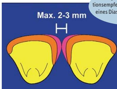
Unabhängig vom gewählten Herstellungsverfahren sollte die Präparationsgrenze als akzentuierte Hohlkehle (120°) gestaltet werden. Hierfür sollten bevorzugt torpedoförmige Diamantschleifer verwendet werden (z. B. 8778.314.012 und 8878.314.014, Fa. Brasseler).
