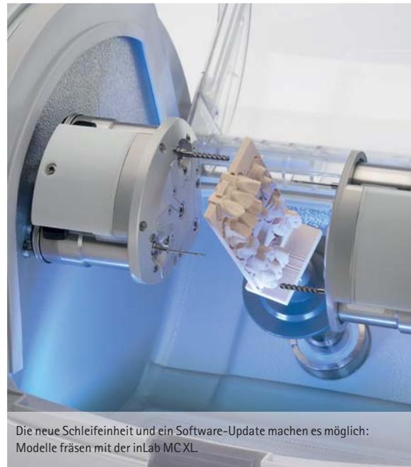
Die neue Schleifeinheit und ein Software-Update machen es möglich: Modelle fräsen mit der inLab MC XL.
