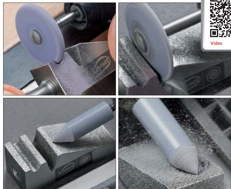
Der neue Abrichtblock erleichtert die Formgebung von Polierern.
