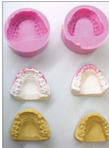
Abb. 3: Silikonform, Anfangsmodelle, Einbettmassenmodelle (gelb).
