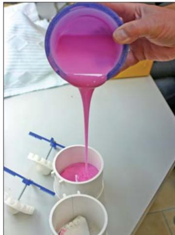
Abb. 2: Herstellung der Dublierform aus Silikon.
