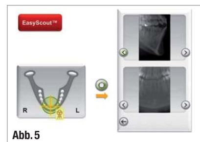
▲ Abb. 5: Intuitive Patientenpositionierungskorrektur mit dem EasyScout™ Verfahren.
