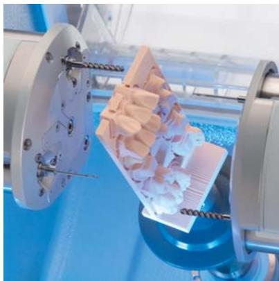
▲ Mit der inLab MC XL Schleifeinheit können u.a. auch Modelle auf Basis digitaler Abformungsdaten (CEREC Connect) gefräst werden.
