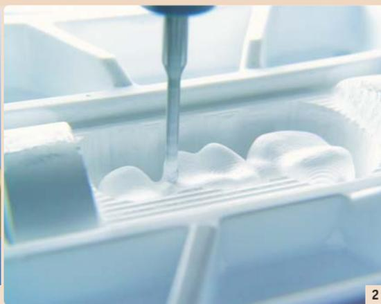
Abb. 1: Computergestützte Rekonstruktion: Scan-Daten des Antagonisten, der funktionellen Bewegung, der Lateralzähne und der Präparation fließen in die Kauflächengestaltung ein. (Foto: Mehl) – Abb. 2: Zirkoniumdioxidkeramik für Kronen und Brücken kann nur mit NC-gesteuerten Fräsautomaten bearbeitet werden. (Foto: 3M ESPE)
