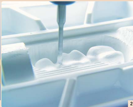
Abb. 1: Computergestützte Rekonstruktion: Scan-Daten des Antagonisten, der funktionellen Bewegung, der Lateralzähne und der Präparation fließen in die Kauflächengestaltung ein. (Foto: Mehl) – Abb. 2: Zirkoniumdioxidkeramik für Kronen und Brücken kann nur mit NC-gesteuerten Fräsaufbauten bearbeitet werden. (Foto: 3M ESPE)
