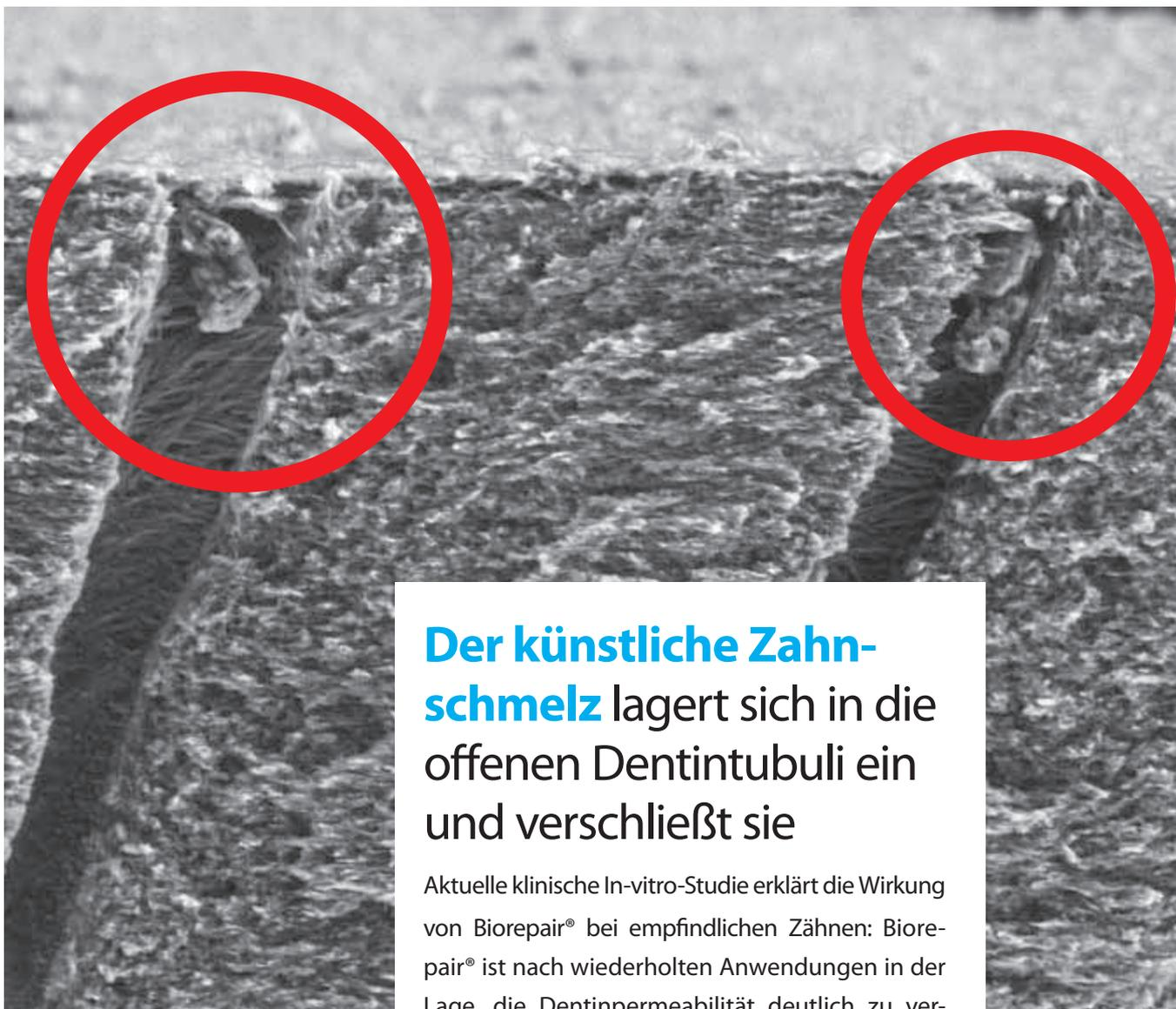
Dentin-Bruchkante nach Applikation von Biorepair®, 10.000-fach vergrößert
