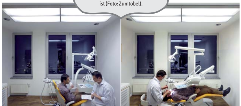
Abb. 3a: Licht folgt der Funktion. Sanftes Licht für das erste Beratungsgespräch hilft dem Patienten, sich zu entspannen und Vertrauen aufzubauen (Foto: Zumtobel). – Abb. 3b: Auf Knopfdruck lässt sich die geforderte hohe Beleuchtungsstärke umstellen, wenn es zum konzentrierten Arbeiten während der Behandlung notwendig ist (Foto: Zumtobel).
