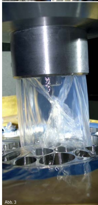
Abb. 1 und 2: Funkenschlag und Wärmebildung beim Fräsen von Titan Blanks ohne Kühlung. – Abb. 3: Schwallkühlung.
