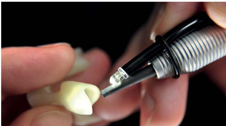
(5.000 Lux) schattenfreies Arbeiten ermöglicht. Mithilfe der im Strahlgriffel integrierten LED-Beleuchtung können selbst kleinste Oxid- und Einbettmassenreste erkannt und
