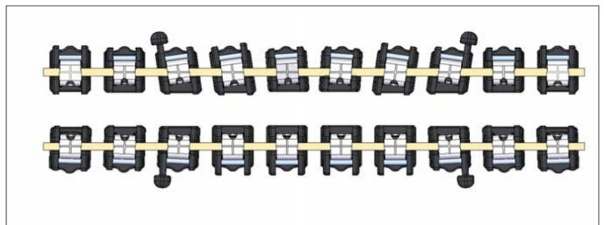
Abb. 2a: Die Brackets in der Übersicht. Bei den angulierten Brackets sind jetzt Deckel und Deckelachse immer im rechten Winkel zueinander.
