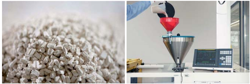
Abb. 4: Ausgangsprodukt ist das Compound. Feines Keramikpulver wird mit einem thermoplastischen Bindersystem vermischt und zu einem spritzgießfähigen Material vermischt. Dieses Compound lässt sich mit ähnlichen Freiheitsgraden wie beim Kunststoffspritzguss verarbeiten. – Abb. 5: Das Compound wird in die Spritzgussanlage eingefüllt. Die Formgebung erfolgt durch Spritzen der Teile auf den speziell ausgerüsteten Spritzgussmaschinen. Hierbei wird das Compound bei hohem Druck in ein Werkzeug gespritzt. Es entsteht der Implantat-Grünling.
