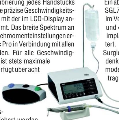
Jedes Programm beinhaltet Einstellungen bzgl. Drehzahl, Drehmoment, Kühlmittelmenge und Drehrichtung. Individuelle Einstellungen können ganz einfach durch Betätigung der Memory-Taste abgespeichert werden und sind somit jederzeit wieder abrufbar.
