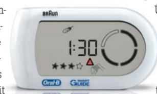
Das erfolgreiche Konzept der kabellosen Übertragung an ein „Navigationssystem“ - der SmartGuide - ist bei der neuen Oral-B Triumph 5000 ebenfalls noch weiter optimiert: Die Symbole der Reinigungsmodi (Reinigen, Tiefenreinigung, Sensitiv, Polieren und Massage) sind neu und vereinfacht im SmartGuide dargestellt, ein optisches Belohnungssystem zeigt durch vier Sterne die erreichte Putzzeit pro Kieferquadrant an (jeweils nach 30 Sekunden füllt sich ein Stern). ◀◀
