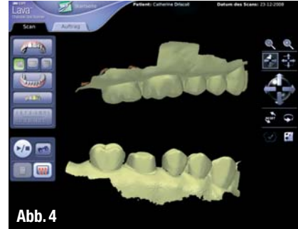
▲ Abb. 2: Kurzwelliges Blaulicht mit Streifenlichtprojektion (Ender); System CEREC. ▲ Abb. 3: Einzelaufnahmen werden zu einem Modell zusammengefügt (Sirona). ▲ Abb. 4: Intraoral-Scan (C.O.S.) eines Quadranten mit Gebenbiss für ein ZrO 2 -Kronengerüst (3M ESPE).
