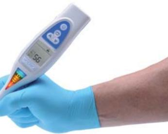
Mit der Bildung von Karies geht ein Demineralisationsprozess und somit die Erhöhung der elektrischen Leitfähigkeit des Zahns einher. Mittels AC- Impedanzspektroskopie (ACIST) misst
