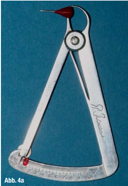
Abb. 4a und b Modifizierter Kronentaster zur Sensibilitätsüberprüfung der N. mentalis.
