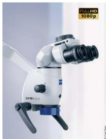
die Bilddaten zur weiteren Verarbeitung oder zur Archivierung direkt in den PC gelangen. Die Full-HD-Kamera und ihre Kontrolleinheit sind komplett in das für die Zahnmedizin entwickelte OPMI pico oder OPMI pico MORA integriert. Dies garantiert ein
