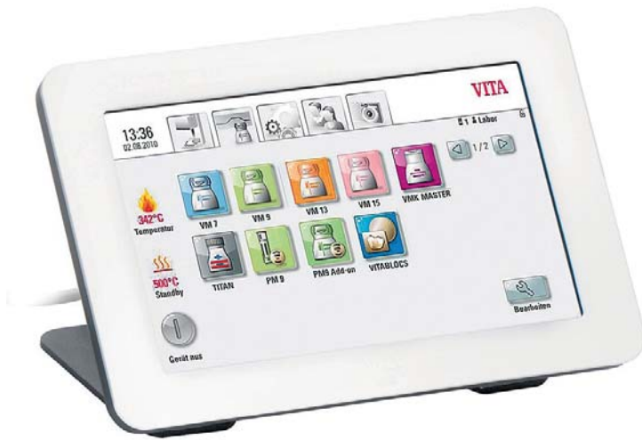
Abb. 2: Durch Berührung der Symbole auf dem zentralen Bedienteil VITA vPad steuert man die Öfen.
