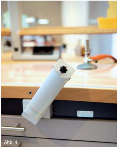
Abb. 4 und 5: Durchdachte Details: Schwenkbarer Ansaugtrichter der Absauganlage oder die Bohrerschubblende mit herausnehmbarem Einsatz sind nur einige Beispiele hierfür.
