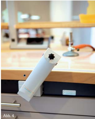
Abb. 4 und 5: Durchdachte Details: Schwenkbarer Ansaugtrichter der Absauganlage oder die Bohrerschublade mit herausnehmbarem Einsatz sind nur einige Beispiele hierfür.
