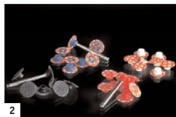
Abb. 1: Das System SwissFlex: SwissFlex Discs in unterschiedlichen Durchmessern (9 und 13 mm) und SwissFlex Strips sind in dem bestehenden Kit übersichtlich angeordnet. Abb. 2: SwissFlex Discs: Verschiedene Farbcodierungen (schwarz, blau, rot, weiss) weisen auf die unterschiedlichen Partikelgrößen der Poliermittel (70 µm, 50 µm, 30 µm, 5 µm) hin. Abb. 3–5: Abrunden aller Kanten der präparierten Pfeiler vor Abformung für eine vollkeramische Restauration mit der Finierscheibe SwissFlex Disc (Farbcodierung: schwarz 70 µm und blau 50 µm). Zur Vermeidung einer Stresskonzentration in der Gerüstkeramik und zur Optimierung des Schleifprozesses von CAD/CAM-gefertigten Gerüsten ist eine inzisale bzw. okklusale Abrundung aller Kanten erforderlich.
