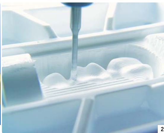
Abb. 1: Computergestützte Rekonstruktion: Scan-Daten des Antagonisten, der funktionellen Bewegung, der Lateralzähne und der Präparation fließen in die Kauflächengestaltung ein. (Foto: Mehl) – Abb. 2: Zirkoniumdioxidkeramik für Kronen und Brücken kann nur mit NC-gesteuerten Fräsautomaten bearbeitet werden. (Foto: 3M ESPE)
