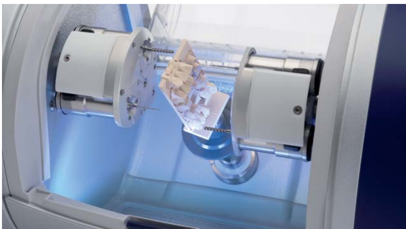
▲ Mit der aktuellen inLab MC XL-Schleifeinheit lassen sich Modelle aus Polyurethan direkt im zahn- technischen Labor fräsen. Alternativ sind Modelle zentral bestellbar.
