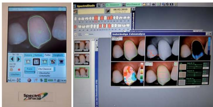
**Abb. 36:** SpectroShade MicroDental Spectrophotometer der Fa. MHT.ch. Darstellung einer direkten Einzelzahnanalyse am Patienten in Office und deren Vervollständigung mit entsprechender Software am PC.
