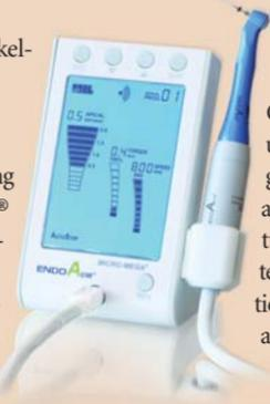
gesteuert über den integrierten Apex-Locator bzw. die Torque-Control. Durch 14 voreingestellte und 9 manuell einstellbare Programme ist es ideal für alle Endoanwendungen. Die Rotationsrichtung zur Befreiung des Instrumentes wechselt automatisch. Die Position der Feile zum Apex in Echtzeit auf dem Bildschirm inklusive akustischem Warnsignal kann genau angezeigt werden.
