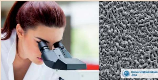
Elektronenmikroskopische Aufnahme der porösen, bioaktiven Titanoxidoberfläche. (Foto: Universitätsklinikum Jena)
