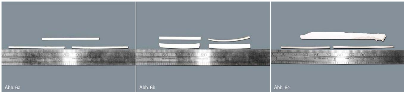
Abb. 6a: Verzugsfreies VITA In-Ceram YZ. – Abb. 6b und c: Generisches Zirkoniumdioxid, welches Verzug zeigt sowie größere Unterschiede in Festigkeit und Homogenität.
