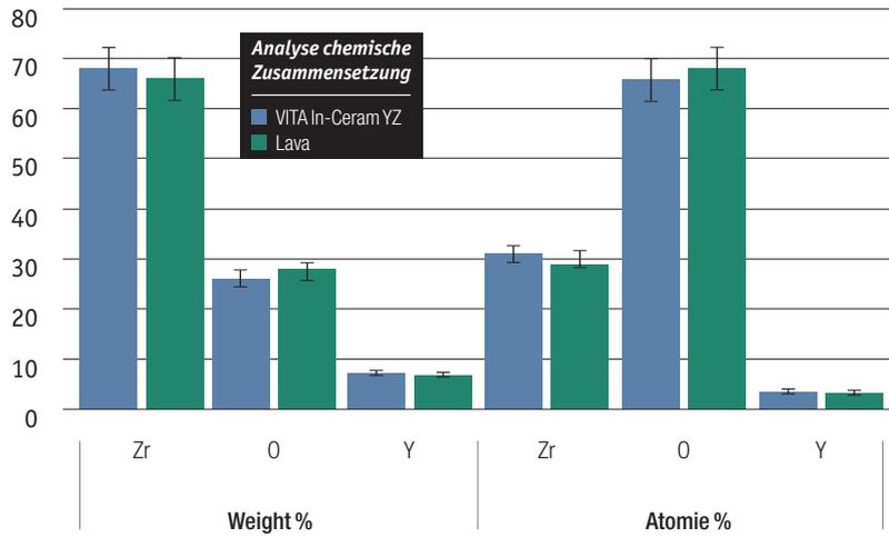
Abb. 5: Analyse der chemischen Zusammensetzung mittels EDX.
