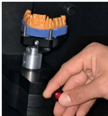
Schnelle und einfache manuelle Einstellung des Scanwinkels per Knopfdruck.
