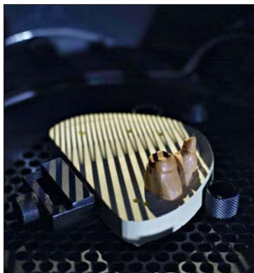
Streifenlichtprojektion gewährleistet höchste Präzision auch bei komplexen Geometrien.
