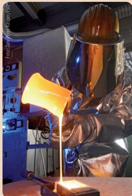
Die Glaskeramiken werden gemäß einem genau angegebenen Temperaturschema erzeugt.
