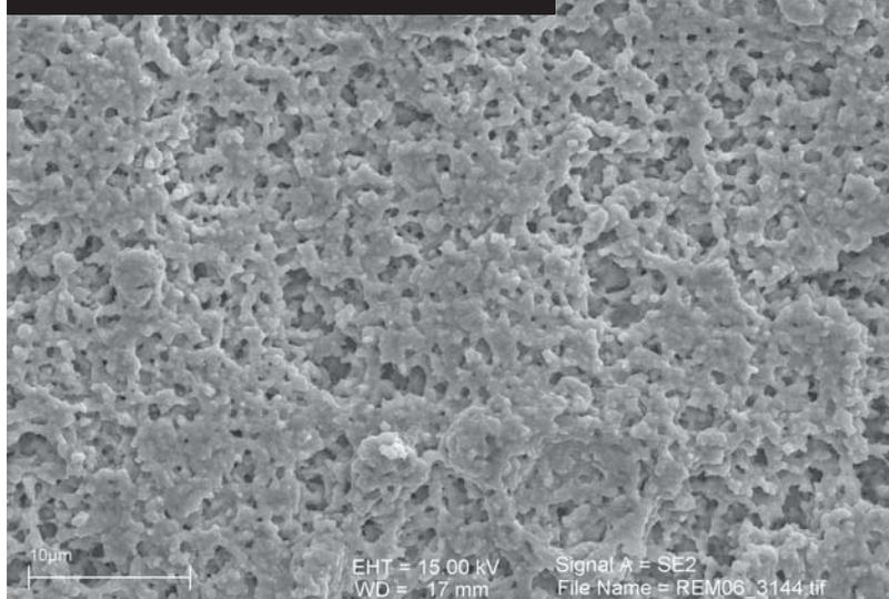
Abb. 2: Mikrostruktur einer reinen  $ZrO_2$ -Oberfläche gestraht.
