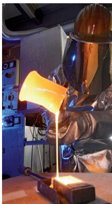
Die Glaskeramiken werden gemäß einem genau angegebenen Temperaturschema erzeugt (Foto: Jan-Peter Kasper/FSU).
