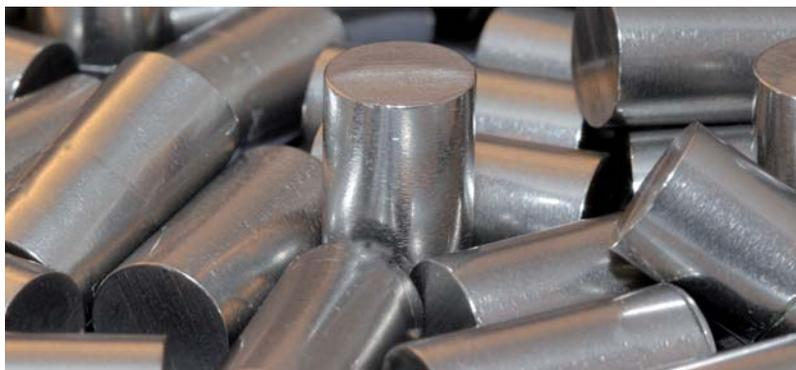
Quattro Steel soft ist eine hochwertige, aufbrennfähige Nichtelegierung auf Kobalt-Basis. Sie bietet optimale technische Eigenschaften und lässt sich leicht vergießen. Weiterhin überzeugt sie mit sehr gutem Ausarbeitsverhalten sowie einer ausgezeichneten Polierbarkeit.
