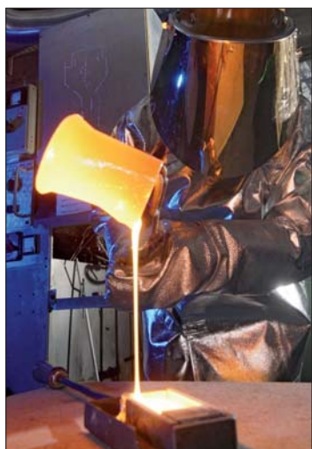
Die Glaskeramiken werden gemäß einem genau angegebenen Temperaturschema erzeugt. (Foto: Jan-Peter Kasper/FSU)
