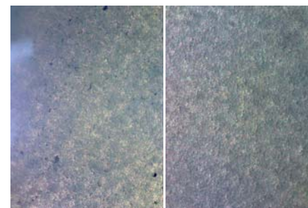
Abb. 12 und 13: Bei 200× Vergrösserung, handgefertigt mit Luftporenschlüssen (12), maschinell gefertigt und homogen (13)
