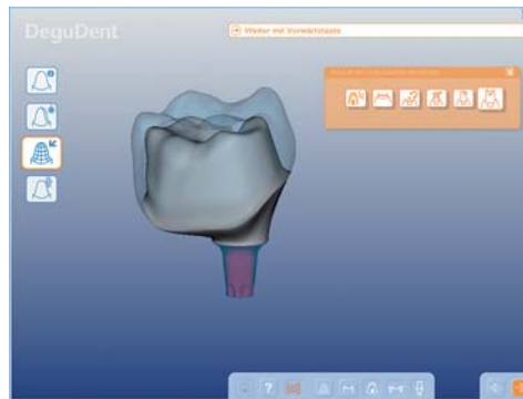
Abb. 9: CAD-Prozess für ein zweiteiliges Zirkonoxidabutment (Cercor Art, DeguDent GmbH, Hanau. – Abb. 10: Lateralansicht der zementierten vollkeramischen Kronen. Das Durchtrittsprofil der Implantatsuprastruktur ist identisch mit einem natürlichen Zahn.
