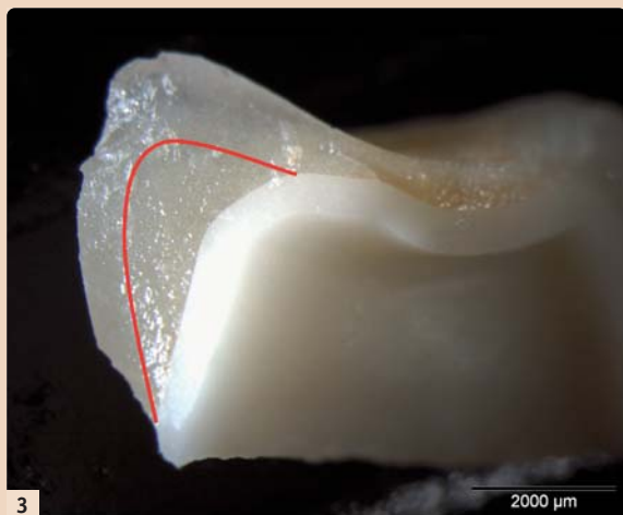
Abb. 3: Fehlede Höckerunterstützung für die Verblendung erhöht das Chipping-Risiko. (Quelle: AG Keramik/Scherrer) – Abb. 4: Geschichtete Verblendungen auf ZrO 2 zeigten in der Kausimulation extendierte Chippingfrakturen im Bereich der Verblendkeramik; LS 2 -Kronen hingegen blieben bei einer simulierten Kaublastung bis 1.100 Newton frakturfrei. (Quelle: Güß) – Abb. 5: Die ausgeschliffenen Einzelteile werden mit einer Konnektor-Keramikmasse verbunden und im Sinterverbundbrand zusammengefügt (System e.max CAD-on, Ivoclar). Die exakte Zahnfarbe stellt sich beim Sintern ein. (Quelle: Beuer/Schweiger)
