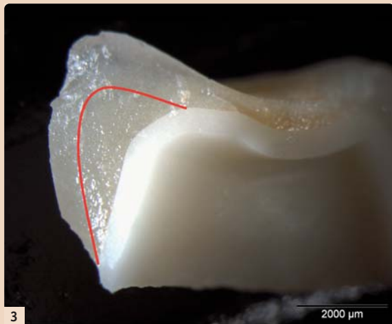
Abb. 3: Fehlende Höckerunterstützung für die Verblendung erhöht das Chipping-Risiko. (Quelle: AG Keramik/Scherrer) –
