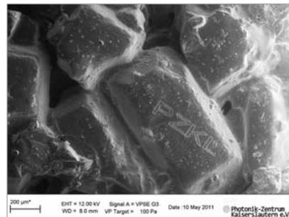
Den Auftraggebern der Tests steht ein breites Anwendungsspektrum zur Auswahl, vom Schneiden bis zur Beschriftung (hier eine 100 µm hohe Gravur auf Kristall). Letztere kann zum Beispiel zur unsichtbaren Produktkennzeichnung genutzt werden.
