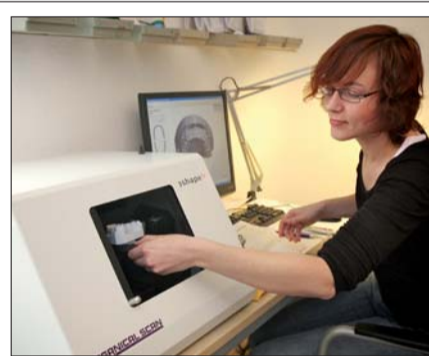
Die Ausgangsmodelle werden dreidimensional gescannt.
