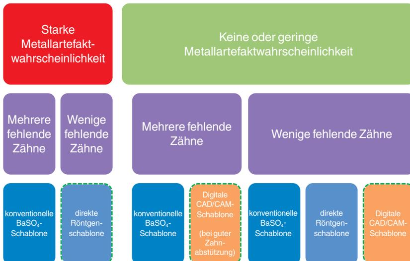
▲ **Abb. 12:** Entscheidungsmatrix für verschiedene Herstellungsverfahren einer Bohrschablone.
