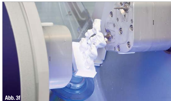
▲ Abb. 3a bis f: Fertigung mit moderner digitaler Technologie: Centric Guide Hardware und Centric Guide Software, 3Shape DentalDesigner, Implantatplanungssoftware, Sirona inLab Software, Fräsmaschine MCXL.
