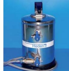
**Inkoquell 6** ist ein Wasseraufbereitungsgerät zur Versorgung von Geräten mit kalkfreiem Wasser bei automatischer Kesselfüllung. Einfache Installation. Das Gerät verhindert durch Teildemineralisierung des Leitungswassers Kalkablagerungen im Dampfstrahlgerät. Robuste Bauweise aus Edelstahl sichert eine einwandfreie Funktion des Gerätes über einen langen Zeitraum. Besonders wirtschaftlich. Einfache Regenerierung durch den Anwender.
