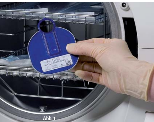
Abb. 1 und 2: Einweg-Helixtest und Mehrweg-Helixtest zur Überwachung der Dampfsterilisation für komplexes Sterilgut inklusive Hohlkörperinstrumente.
