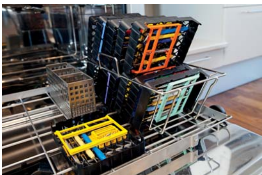
Reinigungskorb für acht komplette oder halbe PractiPal Trays. Zur vollen Umspülbarkeit der Instrumente erfolgt die Sortierung einzeln.
