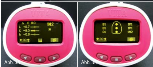
Abb. 2: Das Farbbestimmungssystem VITA Easyshade Advance. – Abb. 3a: Ermittelte Farbkoordinaten einer keramischen Restauration unter Verwendung des Farbbestimmungssystems VITA Easyshade Advance. – Abb. 3b: Farbmusterangaben im Rahmen einer Mehrpunktmessung am natürlichen Zahn.
