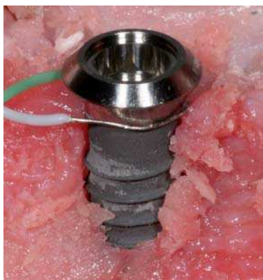
Abb. 3: Versuchsaufbau: digitale Temperaturmessung, Umschlingung des Implantatkopfes mit K-Typ-Thermoelement.
