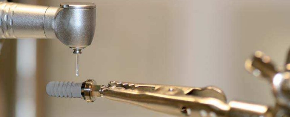
Abb. 4: Versuchsaufbau: simulierte Periimplantitisbehandlung im zahntechnischen Stativ.
