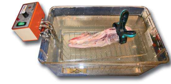
Abb. 2: Versuchsaufbau: Präparat wird konstant auf Körpertemperatur gehalten.
