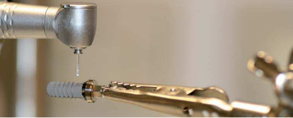
Abb. 4: Versuchsaufbau: simulierte Periimplantitisbehandlung im zahntechnischen Stativ.
