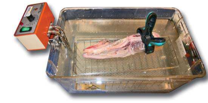
Abb. 2: Versuchsaufbau: Präparat wird konstant auf Körpertemperatur gehalten.
