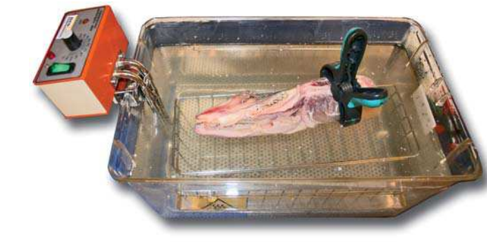
Abb. 2: Versuchsaufbau: Präparat wird konstant auf Körpertemperatur gehalten.
