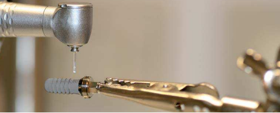
Abb. 4: Versuchsaufbau: simulierte Periimplantitisbehandlung im zahntechnischen Stativ.
