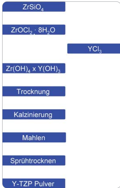
Abb. 3: Y-TZP Pulverherstellungsprozess.
