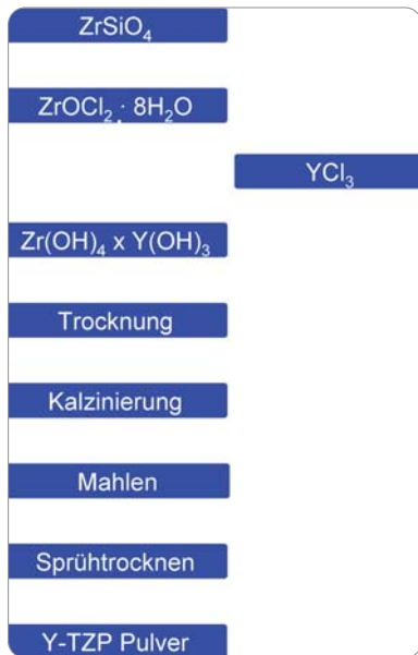
Abb. 3: Y-TZP Pulverherstellungsprozess.
