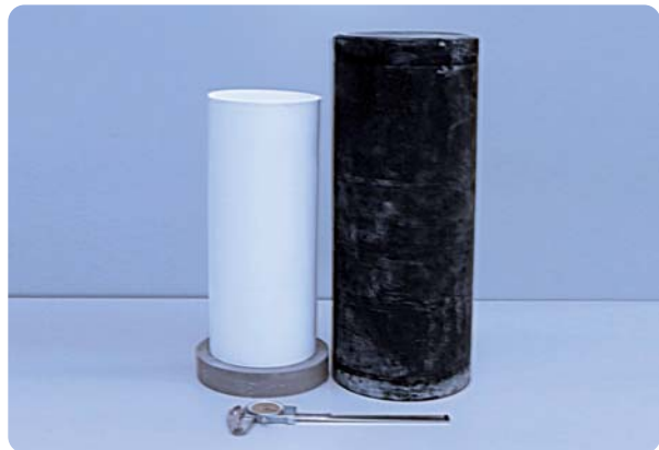
Abb. 5: Ein überdimensionierter Pressling nach dem klassischen, isostatischen Verdichten.
