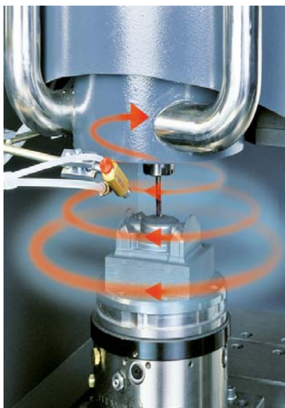
In die Maschinen ist eine patentierte Tornado-Absaugung integriert.
